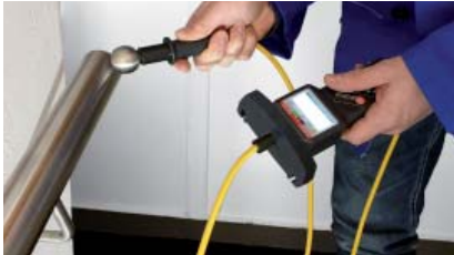
Prüfen von Treppengeländern, die in das Wasser ragen
