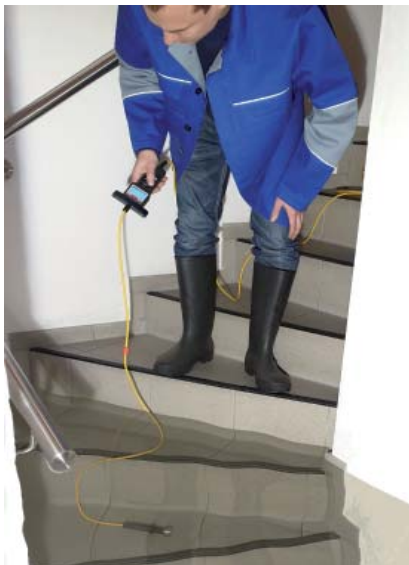
Die Kugelelektrode sondiert Spannung im Wasser aus sicherer Entfernung
