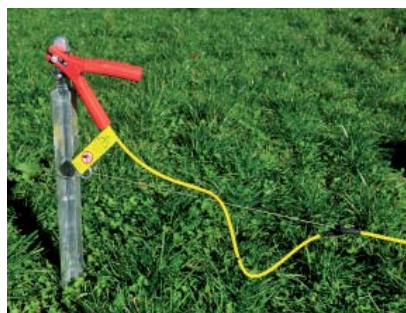
Erdanschluss, z.B. mit Erdspieß durch Klemme mit Zugentlastung
